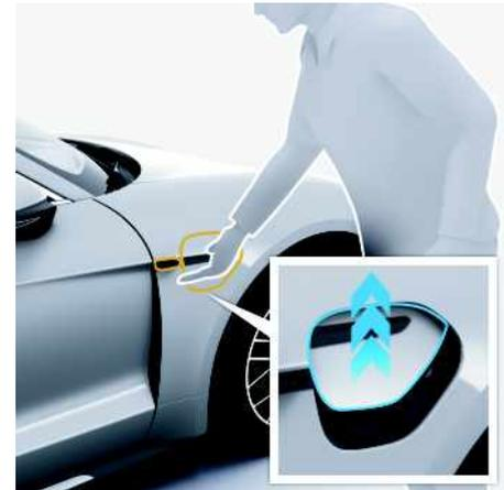
Abb. 113: Ladeklappe öffnen
