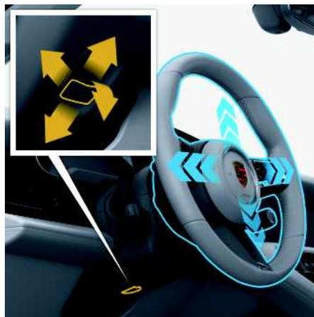
Abb. 120: Steuerschalter Lenkradeinstellung
