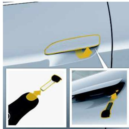
Abb. 235: Notentriegelung/Notverriegelung durchführen
