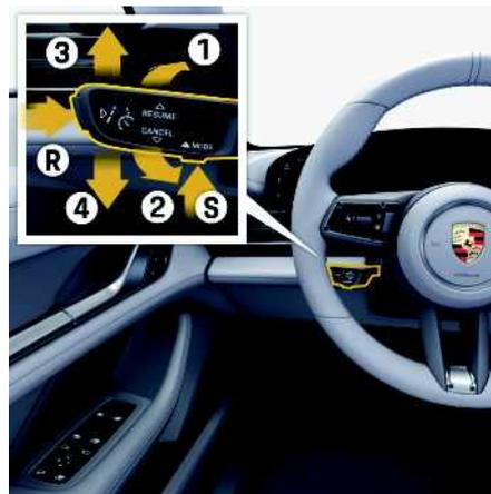
Abb. 218: Bedienelemente Fahrerassistenzsysteme
