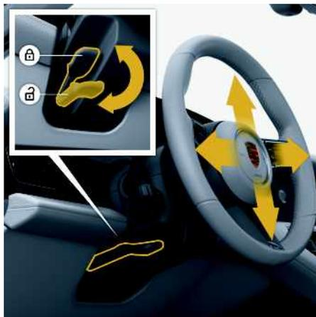
Abb. 119: Hebel Lenkradeinstellung
