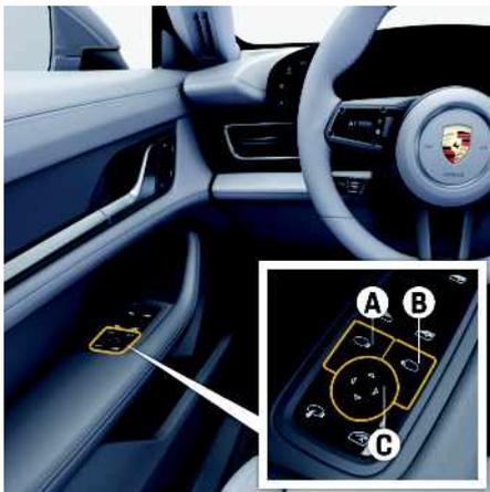
Abb. 198: Spiegelglas als Einparkhilfe nach unten schwenken
