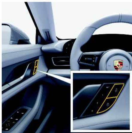
Abb. 232: Taste Zentralverriegelung in der Türverkleidung
