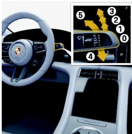
Abb. 175: Scheibenwischerhebel
