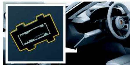
Die Diagnosesteckdose dient dem Anschluss von Diagnosegeräten in qualifizierten Fachwerkstätten. Externe Geräte (z. B. Navigationsgeräte, Head-Up Displays) an der Diagnosesteckdose können die Funktion der Fahrzeugsysteme beeinträchtigen und bei einem ausgeschalteten Fahrzeug die Batterie vollständig entladen und schädigen (Tiefentladung). Die externen Geräte und Kabel können beim Bremsen oder beim Richtungswechsel den Freiraum der Pedale beeinträchtigen oder zwischen die Pedale geraten.
