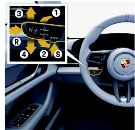
Abb. 62: Bedienehebel Fahrerassistenzsysteme
