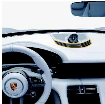
Abb. 91: Oberes Belüftungsfeld
