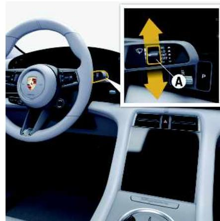
Abb. 176: Schalter für Regensensor-/Intervallbetrieb
