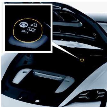
Abb. 28: Bremsflüssigkeitsbehälter
