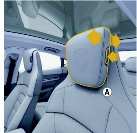
Abb. 188: Längsposition der Kopfstützen der Vordersitze einstellen
