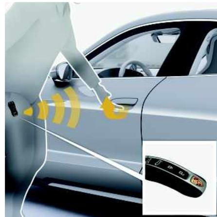
Abb. 1: Türen entriegeln mit Komfortzugang
