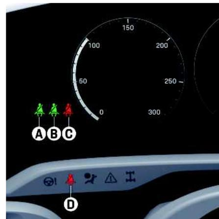
Abb. 177: Gurtstatusanzeige im Kombiinstrument
