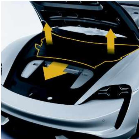
Abb. 102: Kunststoffabdeckung lösen und anheben
