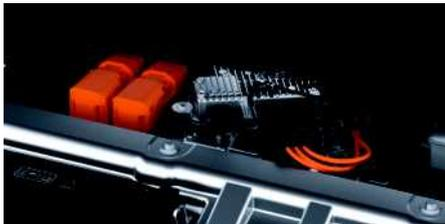
Die Spannung in der elektrischen Anlage des Hochvolt-Bordnetzes und der Hochvolt-Batterie ist lebensgefährlich. Das Berühren von beschädigten Bauteilen der elektrischen Anlage, wie beispielsweise Hochvolt-Kabel, On-Board-Lader, Hochvolt-Zuheizer, Hochvolt-Batterie, Leistungselektronik und Klimakompressor, kann zu einem tödlichen Stromschlag führen.
