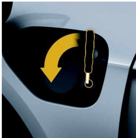
Abb. 116: Notentriegelung der manuellen Ladeklappe
