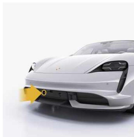
Abb. 11: Position Radarsensor
