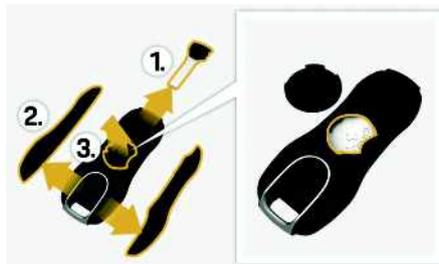
Abb. 48: Batterie wechseln
