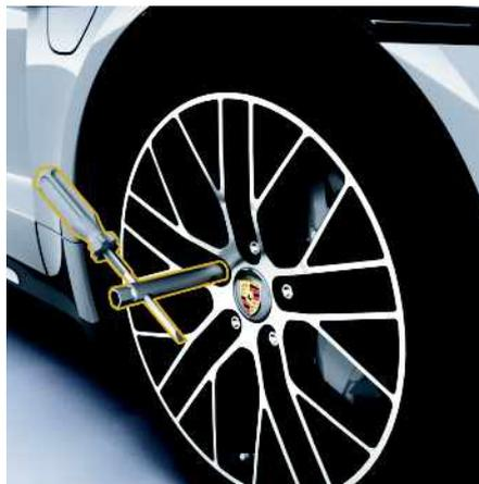
Abb. 173: Eine Montagehilfe bei Fahrzeugen ohne PCCB einschrauben
