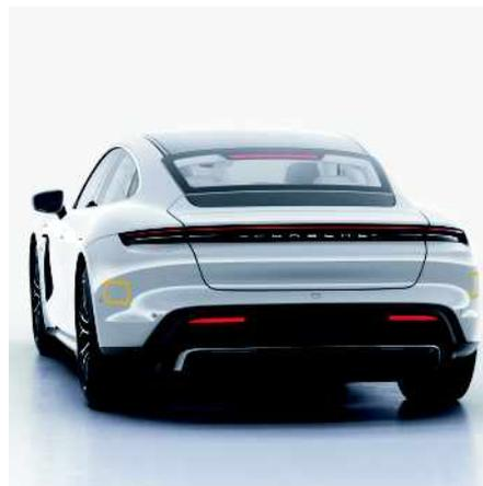
Abb. 207: Radarsensoren im hinteren Stoßfänger
