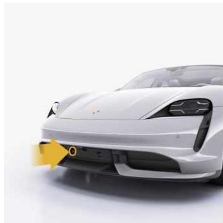
Abb. 153: Position Radarsensor
