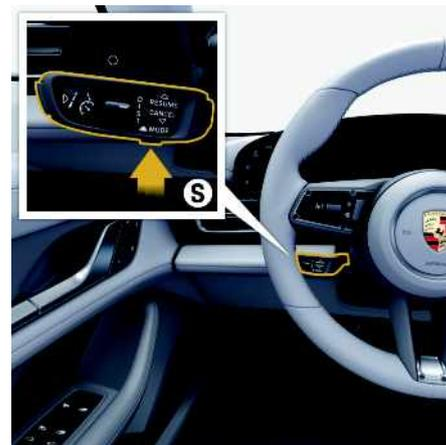
Abb. 22: Bedienhebel Fahrerassistenzsysteme
