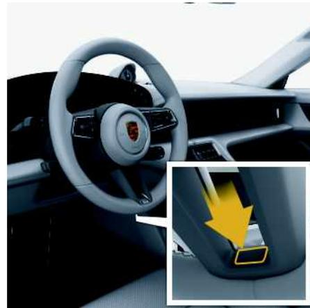
Abb. 121: Taste Lenkradheizung
