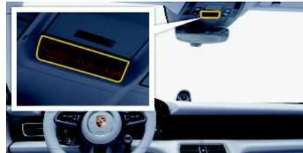
Abb. 80: Anzeige PASSENGER AIR BAG OFF/ON
