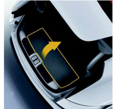
Abb. 104: Kofferraumboden öffnen
