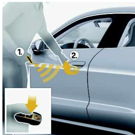
Abb. 230: Türen entriegeln mit dem Fahrzeugschlüssel
