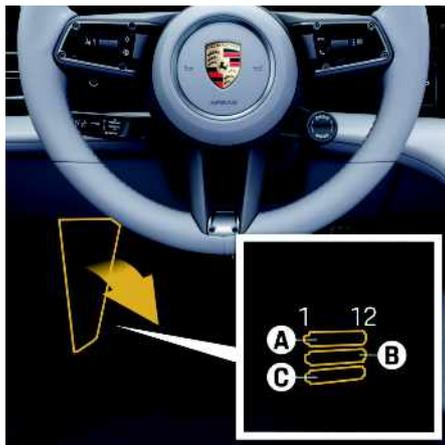
Abb. 183: Sicherungskasten im Fußraum links öffnen
