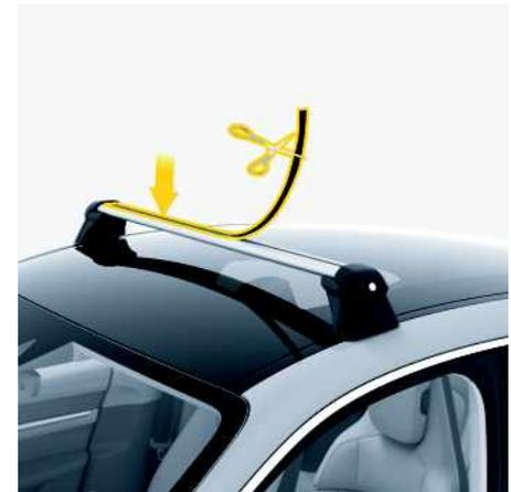
Abb. 43: Profilabdeckung zuschneiden und anbringen
