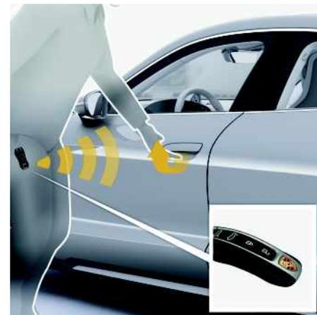
Abb. 231: Türen entriegeln mit Komfortzugang
