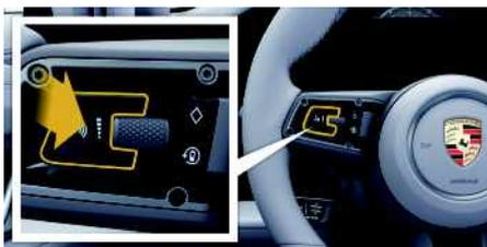
Abb. 203: Lenkrad mit Sprachbedientaste
