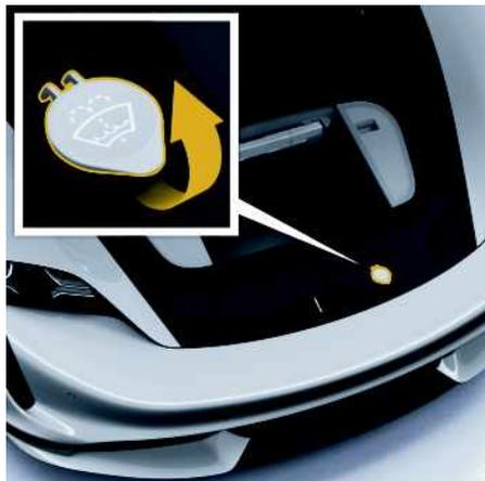
Abb. 224: Waschflüssigkeitsbehälter
