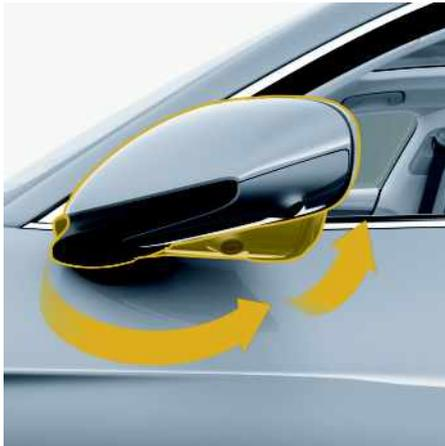
Abb. 197: Außenspiegel an- und ausklappen
