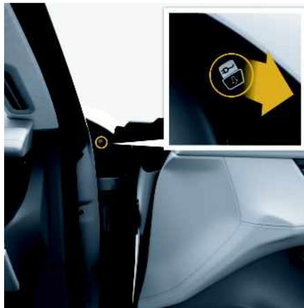
Abb. 118: Notentriegelung des Fahrzeugladesteckers durchführen
