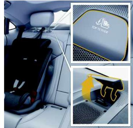
Abb. 83: Befestigungspunkte für Verankerungspunkt (Top Tether)
