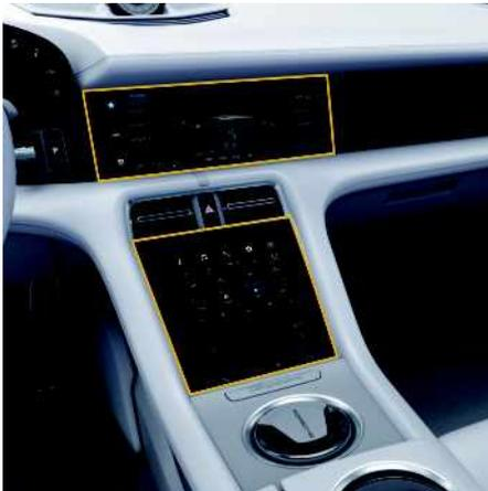
Abb. 4: Bedienfelder der Klimaanlage
