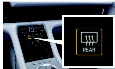
Abb. 97: Softkey Heckscheiben-/Außenspiegelheizung
