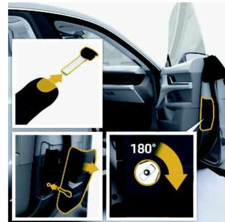
Abb. 236: Notverriegelung der Beifahrertür durchführen
