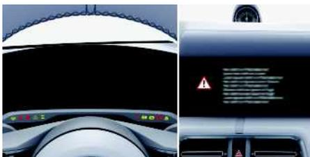
Wenn die Systeme Fehlfunktionen oder defekte Teile erkennen, warnt Ihr Fahrzeug Sie mit Leuchten oder Meldungen im Kombiinstrument oder Zentraldisplay. Wenn Sie Warnsignale des Fahrzeugs nicht beachten, kann die Gefahr von Unfällen, Verletzungen und Beschädigungen am Fahrzeug steigen.
