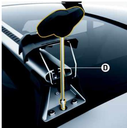
Abb. 39: Befestigungsschrauben anziehen
