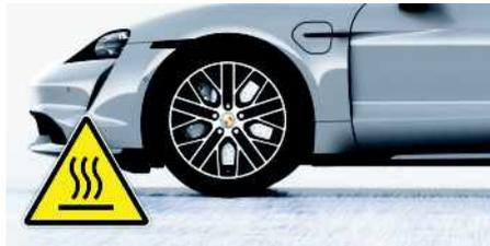
Fahrzeugteile im Fahrwerksbereich und angrenzende Bauteile werden im Fahrbetrieb sehr heiß.
