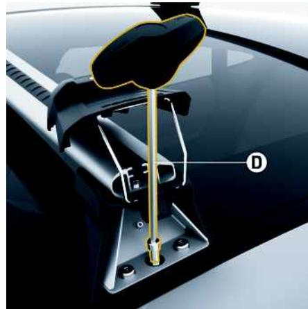
Abb. 35: Befestigungsschrauben anziehen
