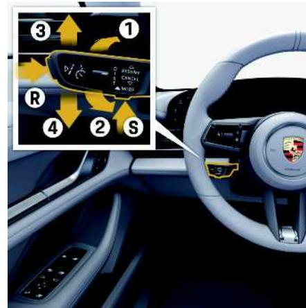
Abb. 15: Bedienelemente Fahrerassistenzsysteme
