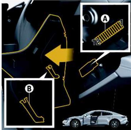
Abb. 181: Sicherungskasten links
