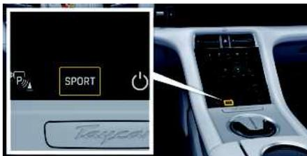
Abb. 44: Schaltfläche für Fahrmodus SPORT
