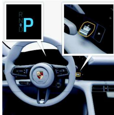
Abb. 49: Anzeige Fahrstufe
