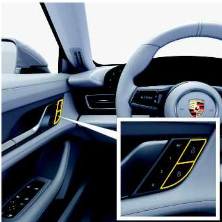
Abb. 234: Taste Zentralverriegelung in der Türverkleidung
