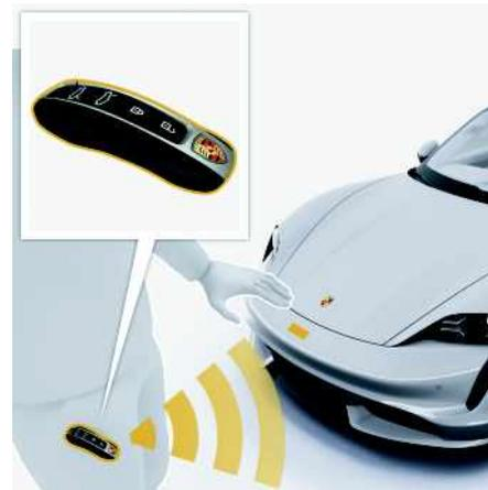
Abb. 56: Fronthaube mit Komfortzugang öffnen
