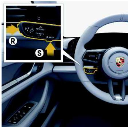
Abb. 205: Bedienelemente Fahrerassistenzsysteme
