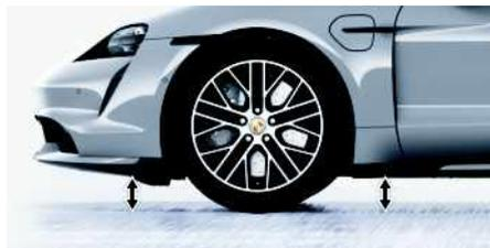
Das Fahrzeug hat eine geringe Bodenfreiheit und kann dadurch leicht aufsetzen.
