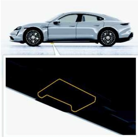
Abb. 221: Aufnahmepunkt Wagenheber oder Hebebühne vorn
