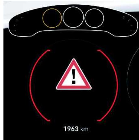
Abb. 223: Kollisionswarnung im Kombiinstrument
